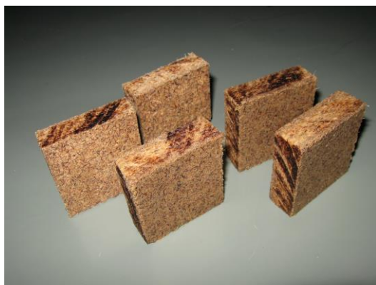
รูปที่ 3 ชิ้นส่วนที่ตัดและนำไปทดสอบสมบัติขนาด 50 มิลลิเมตร X 50 มิลลิเมตร
