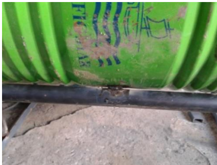
รูปที่ 3 การเชื่อมต่อแถบนวดเข้ากับลูกนวด
