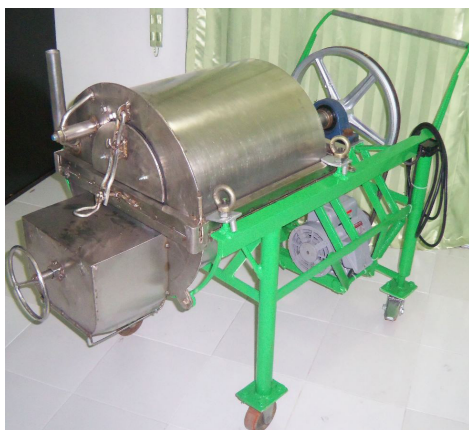
ข) เครื่องแยกเนื้อตาลสุกต้นแบบ รูปที่ 3 แบบและเครื่องแยกเนื้อตาลสุกต้นแบบ
