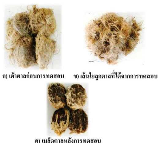
รูปที่ 4 ก) เต้าตาลสุกที่ใช้ทดสอบ ข) เส้นใยลูกตาล และ ค) เมล็ดตาลที่ได้จากการทดสอบ
