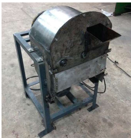
ข) เครื่องแยกเส้นใยลูกตาลสุกต้นแบบ รูปที่ 3 แบบและเครื่องแยกเส้นใยลูกตาลสุกต้นแบบ
