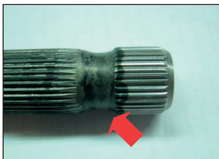
รูปที่ 9 รูปตัวอย่างชิ้นงานที่เกิดจากความสูญเสียที่เกิดจากขั้นตอนกระบวนการให้ความร้อน
