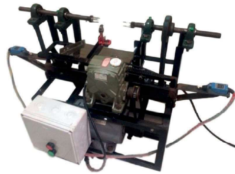
รูปที่ 6 เครื่องลอกเปลือกผีเสื้อกึ่งอัตโนมัติ
