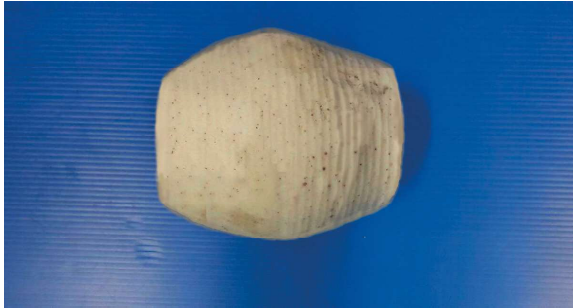
รูปที่ 11 ผลเปลือกที่ผ่านการลอกด้วยเครื่องที่ระดับความเร็วรอบต่ำ (8 รอบ/นาที)
