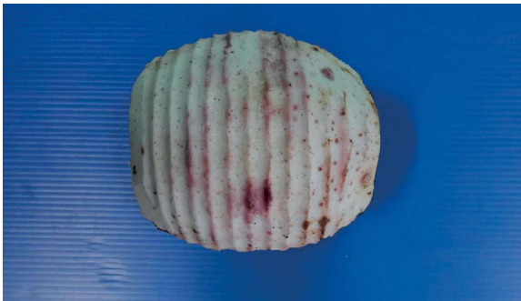
รูปที่ 12 ผลเปลือกที่ผ่านการลอกด้วยเครื่องที่ระดับ ความเร็วรอบสูง (12, 16, 20 และ 24 รอบ/นาที)
