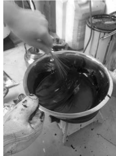
รูปที่ 4 การผสมแอสฟัลต์กับผงยางในรถจักรยานยนต์
