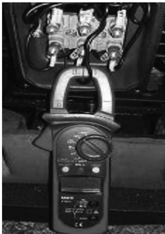
รูปที่ 3 การวัดปริมาณกระแสไฟฟ้าด้วยแอมป์มิเตอร์
