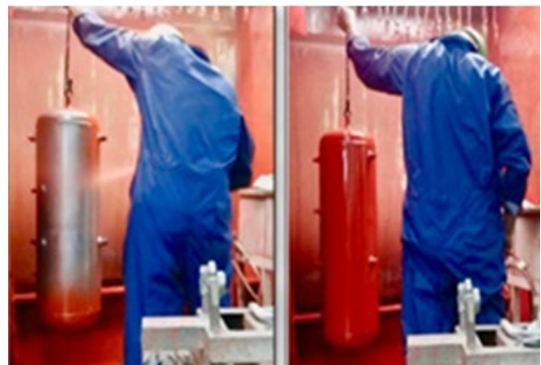
รูปที่ 6 การทำงานในกระบวนการพ่นสีรองพื้น
