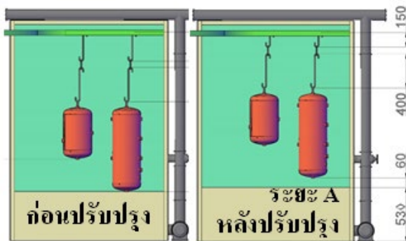
รูปที่ 10 ระดับม่านน้ำในขั้นตอนการพ่นสีรองพื้น
