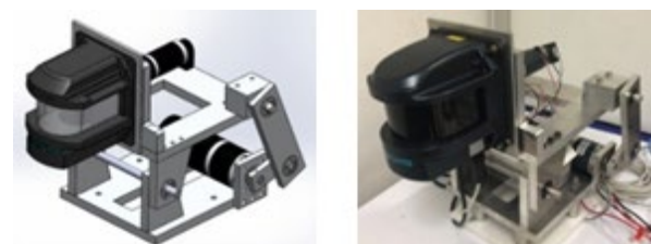
รูปที่ 2 ชุดกลไกการเพิ่มประสิทธิภาพของเลเซอร์สแกนเนอร์ที่ได้ออกแบบ (ซ้าย) และ ที่ได้สร้างขึ้นพร้อมติดตั้งอุปกรณ์และเซนเซอร์ต่างๆ (ขวา)
