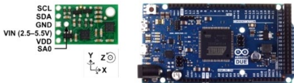
รูปที่ 7 เซนเซอร์วัดมุมเอียงแบบ 9 แกนขนาดเล็ก (MiniIMU-9) ของ Pololu [10] (ซ้าย) และ ไมโครคอนโทรลเลอร์ Arduino DUE [11] (ขวา)
