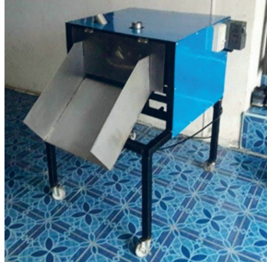
รูปที่ 6 ลักษณะเครื่องสไลด์เห่าบัว
