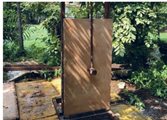
รูปที่ 5 การทดสอบการกระแทกด้วยวัสดุแข็ง ของตัวอย่าง
