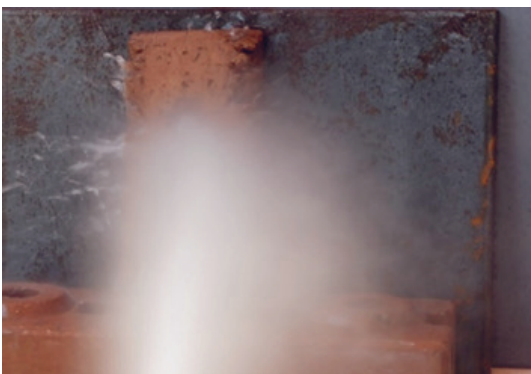
รูปที่ 3 การทดสอบการชะล้างของตัวอย่าง
