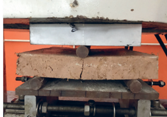
รูปที่ 4 การทดสอบความต้านทานแรงคัต ของตัวอย่าง
