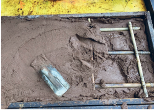
รูปที่ 2 การขึ้นรูปตัวอย่างขนาด 60x120x15 เซนติเมตร
