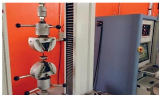
รูปที่ 3 การทดสอบความต้านทานแรงดึงตั้งฉากที่ผิวหน้า
