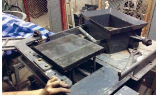
รูปที่ 2 การขึ้นรูปด้วยเครื่องอัดแผ่นซีเมนต์บอร์ด
