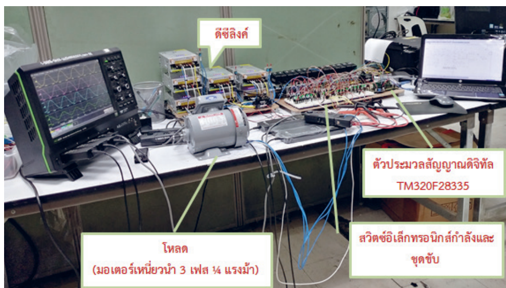
รูปที่ 11 ชุดทดลองต้นแบบอินเวอร์เตอร์หลายระดับแบบที่ 19 ระดับ 3 เฟส
