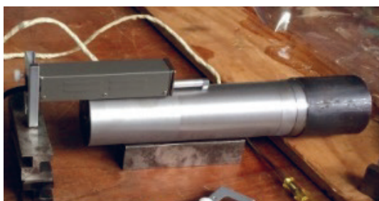
รูปที่ 4 การวัดค่าความหยาบผิวด้วยเครื่อง Kozaka Laboratory Ltd. Surfscorder SE-40 D
