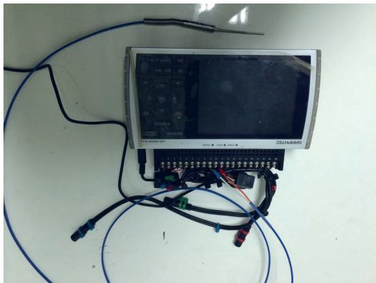
รูปที่ 3 เครื่องวัดอุณหภูมิ เทอร์โมคัปเปิลแบบ J ติดตั้งกับเครื่องบันทึกผล Graphtec midi logger gl800
