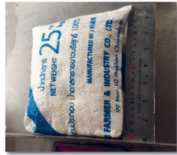
รูปที่ 3 วัสดุทดสอบน้ำตาลแข็งเสมอกันตลอด แนว (ก) และน้ำตาลแข็งตัวในกระสอบ (ข)
