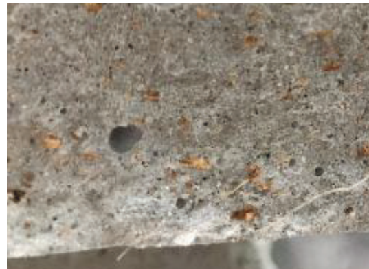
รูปที่ 15 ลักษณะเนื้อและช่องว่างของแผ่นตัวอย่างเปลือกอาคารที่วิบัติจากทดสอบความต้านทานแรงดัด
