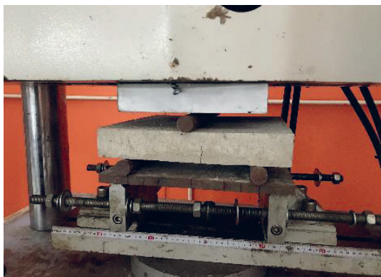
รูปที่ 4 การทดสอบความต้านทานแรงดัดของแผ่นตัวอย่างเปลือกอาคารด้วยเครื่อง UTM
