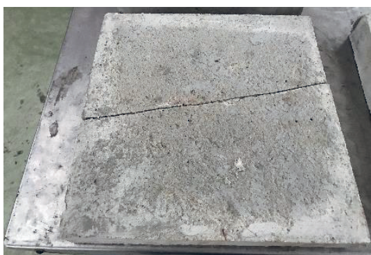
รูปที่ 5 แผ่นตัวอย่างเปลือกอาคารที่วิบัติจากการทดสอบความต้านทานแรงดัด
