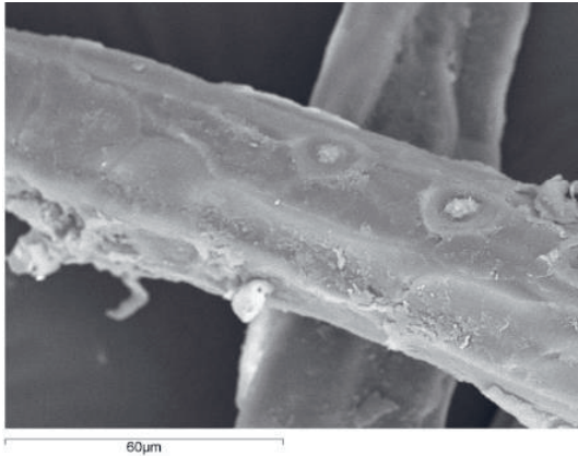
รูปที่ 2 ภาพขยายเส้นใยมะพร้าวที่สอดด้วย กล้อง SEM กำลังขยาย 1,000 เท่า
