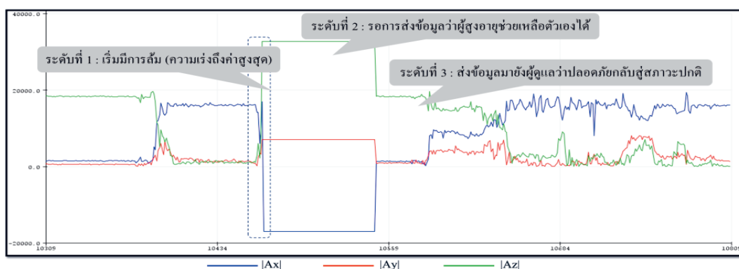
รูปที่ 4 กราฟสัญญาณที่ได้จากการตรวจจับการล้ม 3 ระดับ
