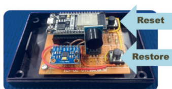
รูปที่ 9 ลักษณะอุปกรณ์ตรวจจับการล้ม
