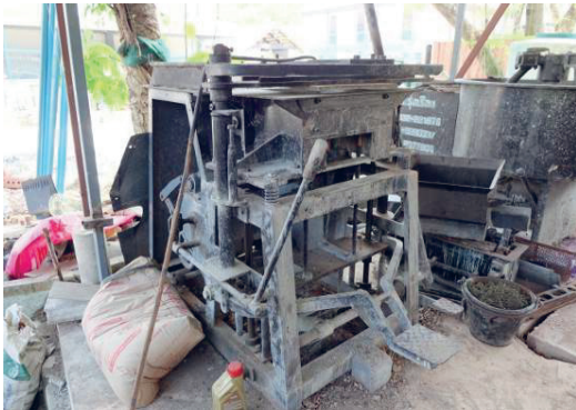
รูปที่ 3 เครื่องอัดกระเบื้องคอนกรีตปูพื้นแบบสั่นเขย่า
