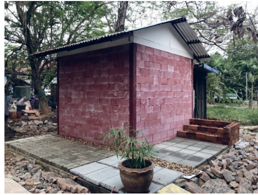
รูปที่ 17 การนำแผ่นกระเบื้องคอนกรีตปูพื้นผสมเศษถนนยางมะตอยเก่าไปใช้งานจริง
