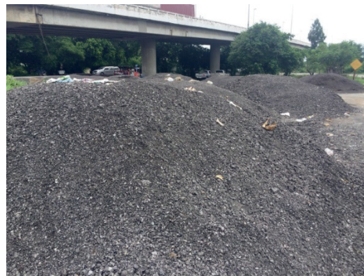
รูปที่ 1 เศษถนนยางมะตอยเก่าที่กองรวมกันรอการกำจัด
