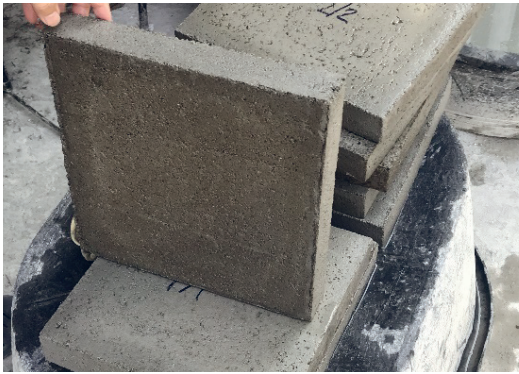
รูปที่ 10 การตรวจพินิจลักษณะทั่วไปของแผ่นกระเบื้องคอนกรีตปูพื้นผสมเศษถนนยางมะตอยเก่า
