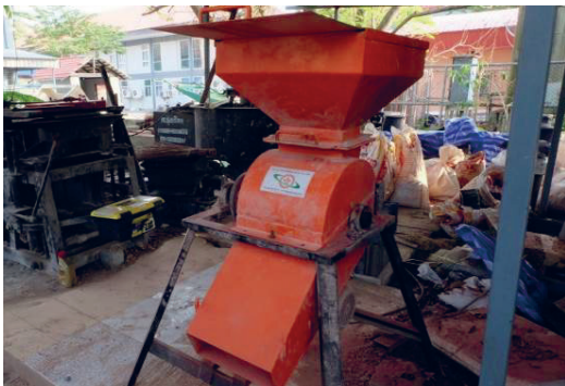
รูปที่ 4 เครื่องย่อยหินพร้อมตะแกรงคัดขนาด
