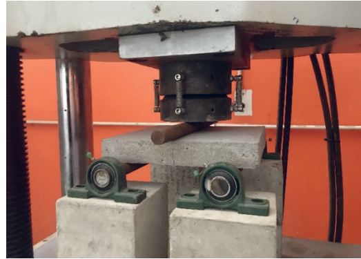
รูปที่ 8 การทดสอบความต้านทานแรงดัดตามขวาง
