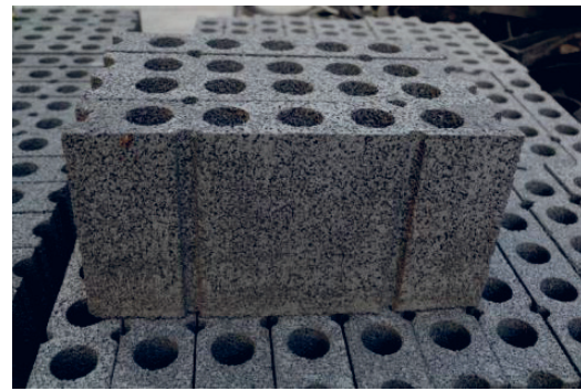
รูปที่ 9 ลักษณะพื้นผิวของคอนกรีตบล็อกแก้วผสมเศษตะกอนน้ำส้มสายชู
