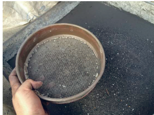
รูปที่ 2 การร่อนเถ้าแกลบผ่านตะแกรง
