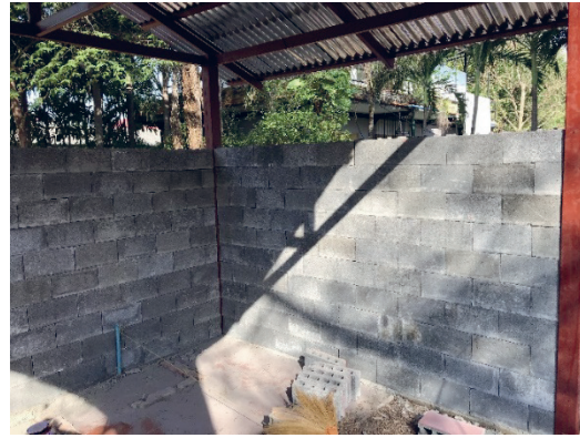
รูปที่ 16 การทดลองก่อผนังอาคารด้วยคอนกรีตบล็อกเถ้าแกลบผสมเศษดินมันสำปะหลัง
