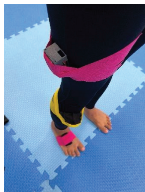
ภาพประกอบ 15 การติดตั้งเซนเซอร์
