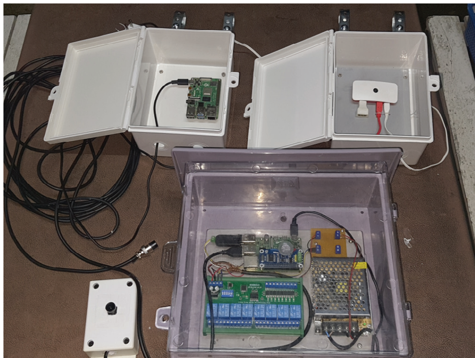
ภาพประกอบ 8 ชุดอุปกรณ์ตัวแบบการตรวจวัดการเจริญเติบโตของพืช
