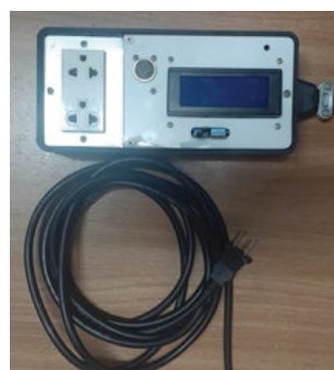
(ข) Smart Breaker ในกล่องพร้อมใช้งาน
