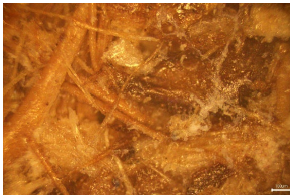
รูปที่ 5 แผ่นปาร์ติเกิลบอร์ดจากเปลือกหมาก (ขนาด 20 มิลลิเมตร ตัวประสาน 12 เปอร์เซ็นต์โดยน้ำหนัก) เสริมแรงด้วยเม็ดพลาสติกกรีไซเคิล
