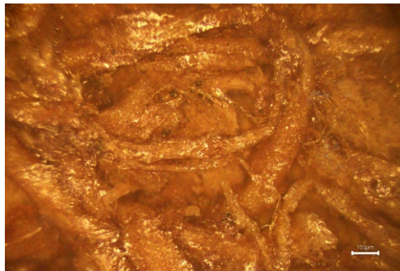
รูปที่ 4 แผ่นปาร์ติเกิลบอร์ดจากเปลือกทุเรียน (ขนาด 20 มิลลิเมตร ตัวประสาน 12 เปอร์เซ็นต์โดยน้ำหนัก) เสริมแรงด้วยเม็ดพลาสติกกรีไซเคิล
