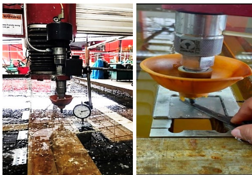
รูปที่ 3 การตั้งเครื่องเพื่อตัดชิ้นงาน
