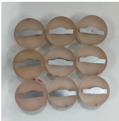
รูปที่ 4 ชิ้นงานหล่อเรซินเตรียมทดสอบความแข็งแรง
