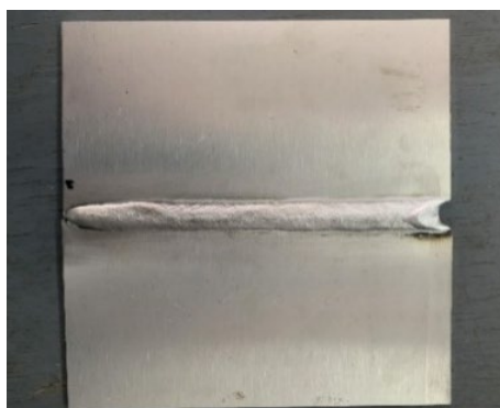
รูปที่ 3 ชิ้นงานจากการทดลองเชื่อมด้วยหุ่นยนต์เชื่อม
