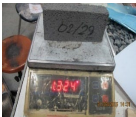
รูปที่ 7 การทดสอบการดูดซึมน้ำของอิฐ
