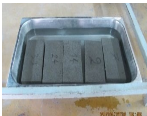
รูปที่ 7 การทดสอบการดูดซึมน้ำของอิฐ
