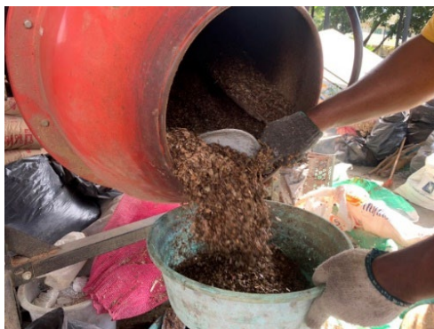
รูปที่ 2 ขั้นตอนการผสมวัตถุดิบกับตัวประสาน
