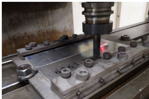
รูปที่ 3 ทดลองเชื่อมชิ้นงานตามเงื่อนไขที่กำหนด
