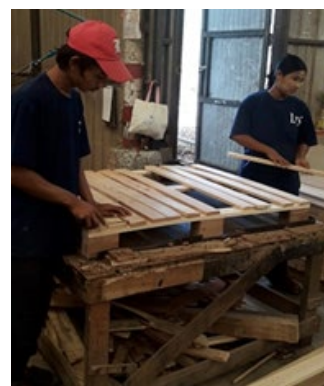
(ค) วางไม้คานประกอบบน
