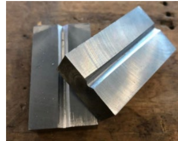
(ข) ลักษณะชิ้นงานทดสอบก่อนเชื่อม
