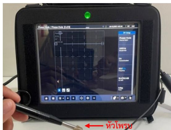
รูปที่ 3 เครื่องตรวจสอบด้วยวิธีกระแสไหลวน
