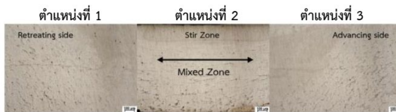
รูปที่ 8 โครงสร้างจุลภาคบริเวณรอยเชื่อมที่ความเร็วรอบ 1240 รอบ/นาที เวลาเชื่อม 30 วินาที
