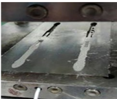
รูปที่ 7 การใส่วัสดุในแม่พิมพ์ก่อนการอัดขึ้นรูป
