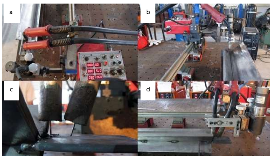
รูปที่ 3 การประกอบติดตั้งเครื่องเชื่อม เครื่องช่วยเชื่อม
