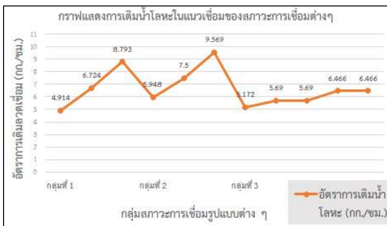
รูปที่ 6 แนวโน้มการเติมน้ำโลหะเพิ่มขึ้นเมื่อกระแสไฟเชื่อมสูงขึ้น
