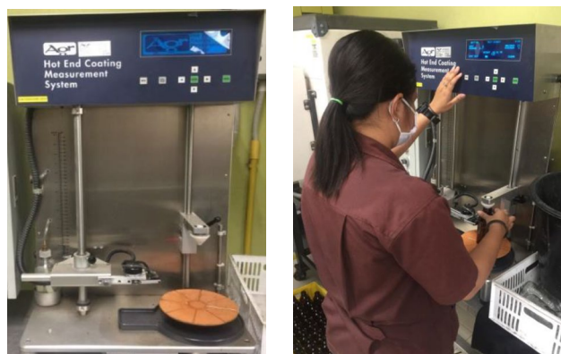
รูปที่ 4 การตรวจสอบค่า ฮอท เอนด์ โคทติ้ง
