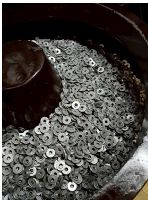
รูปที่ 3 ชิ้นงานที่ผลิตจากกระบวนการโลหะผง
