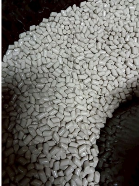
รูปที่ 2 ลักษณะของเม็ดขัดเซรามิก (Ceramic Abrasive Media) ทรงกระบอกตัดเฉียง ขนาด 5x10 มิลลิเมตร
