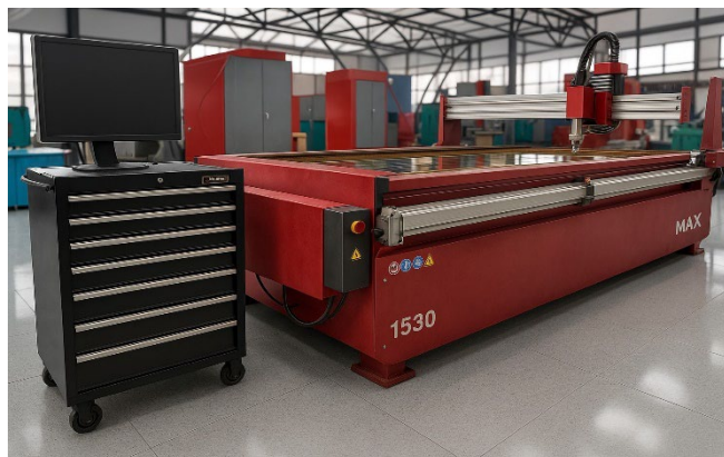
รูปที่ 2 เครื่องตัดด้วยแรงดันน้ำสูงผสมสารขัด (Abrasive Water Jet Cutting Machine) ยี่ห้อ OMAX รุ่น 1530
