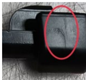
รูปที่ 6 ลักษณะข้อบกพร่องประเภทรอยทางฉีก
