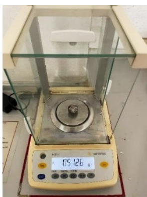
รูปที่ 15 ชั่งน้ำหนักตัวอย่างเชื้อเพลิง RDF-5 0.5 กรัม
