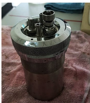
รูปที่ 17 นำตัวอย่างเชื้อเพลิง RDF-5 ใส่กระบอกล แคลซูลแล้วปิดให้แน่น
