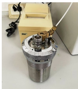
รูปที่ 18 นำมาอัดออกซิเจน
