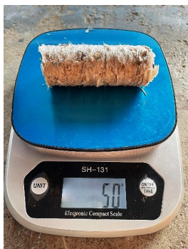
รูปที่ 21 ชั่งน้ำหนักเชื้อเพลิง RDF-5
