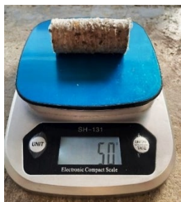
รูปที่ 13 ชั่งน้ำหนักเชื้อเพลิง RDF-5
