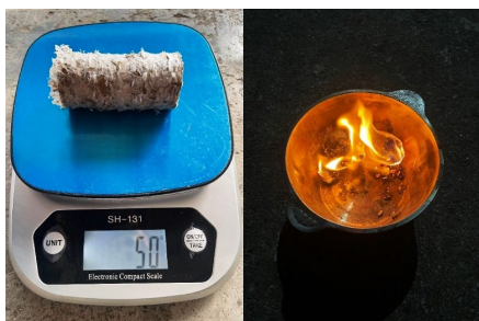
รูปที่ 25 ชั่งน้ำหนักเชื้อเพลิง RDF-5 แล้วนำมาเผา
