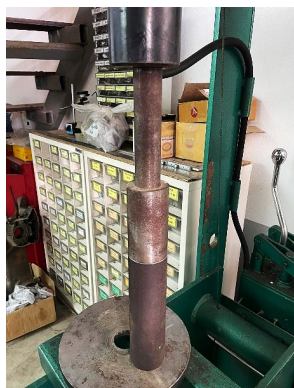
รูปที่ 11 อัดด้วยแท่นอัดไฮดรอลิก
