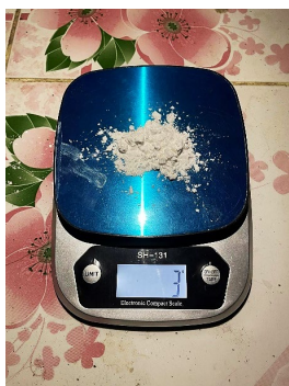
รูปที่ 8 ชั่งน้ำหนักแป้งมันสำปะหลังร้อยละ 2
