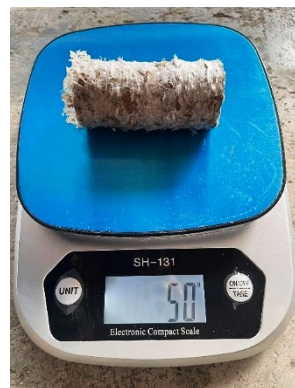
รูปที่ 12 เชื้อเพลิง RDF-5 ที่ได้จากกากอัด
