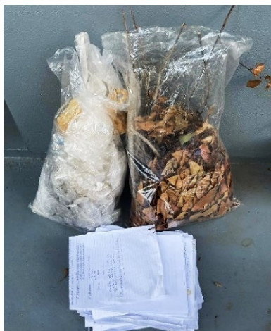
รูปที่ 3 วัสดุผสมRDF-5 กระดาษ พลาสติก กิ่งไม้และใบไม้
