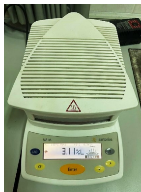
รูปที่ 20 ปิดฝาครอบเครื่องทดสอบความชื้น
