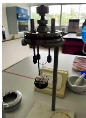
รูปที่ 16 นำปลายเส้นด้ายแต่ละกับตัวอย่างเชื้อเพลิง RDF-5
