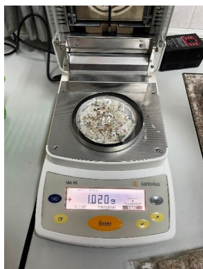
รูปที่ 19 ชั่งน้ำหนักตัวอย่างเชื้อเพลิง RDF-5 1 กรัม
