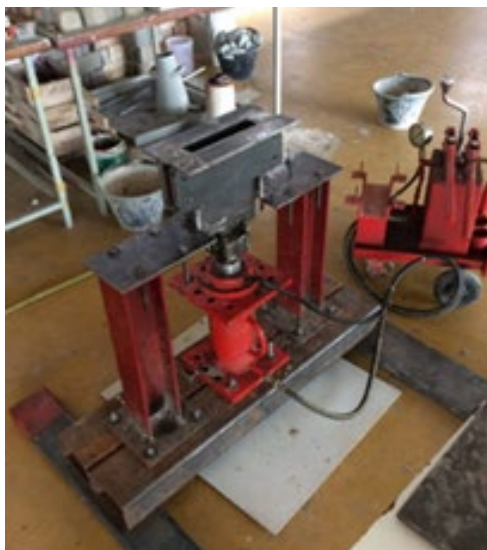
รูปที่ 1 เครื่องอัดอิฐที่ใช้ในงานวิจัย
