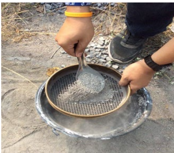
รูปที่ 3 การเตรียมหินฝุ่นก่อนนำไปใช้งาน
