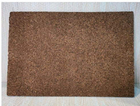
รูปที่ 4 ปาร์ติเกิลบอร์ดจากวัสดุเหลือใช้ทางการเกษตร
