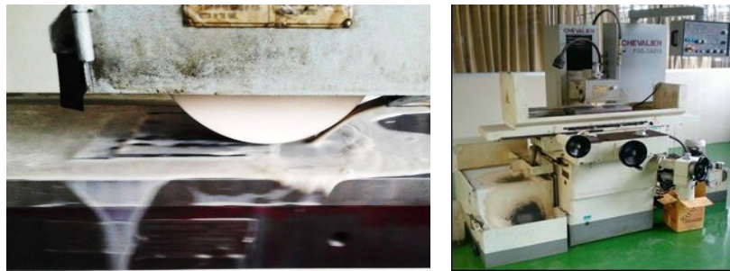
รูปที่ 1 กระบวนการเจียรไนราบด้วยล้อหินเจียรไนอะลูมิเนียมออกไซด์
