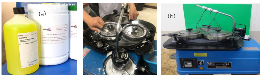
รูปที่ 2 (a) ผงขัดอลูมินา ( Al_2O_3 ) (b) เครื่องขัดผิวละเอียด lap-master model 15
