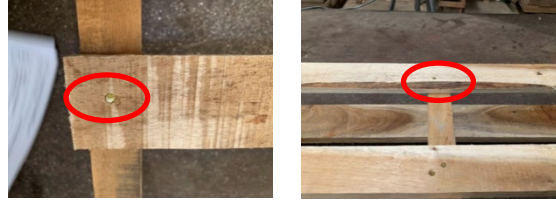
รูปที่ 8 ตรวจสอบหัวตะปูและรอยไม้แตก
