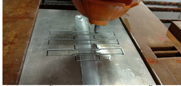
รูปที่ 4 การตัดชิ้นทดสอบด้วยเครื่องตัดวัสดุด้วยน้ำแรงดันสูง
