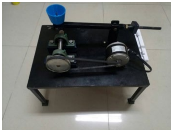
รูปที่ 2 เครื่องทดสอบการสึกหรอมาตรฐาน ASTM G77
