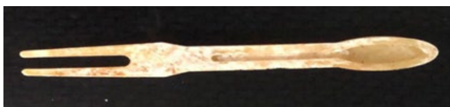
รูปที่ 8 ชิ้นงานแป้งสาลีที่ขึ้นรูปได้ดี
