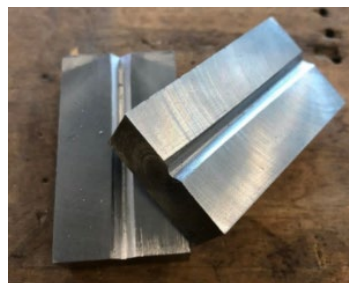
(ข) ลักษณะชิ้นงานทดสอบก่อนเชื่อม
