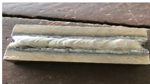
รูปที่ 2 ตัวอย่างรอยเชื่อม SMAW และ GMAW
