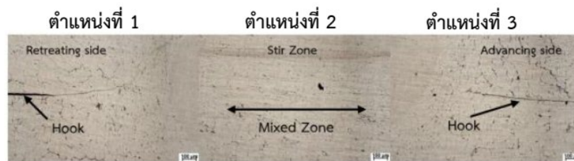
รูปที่ 9 โครงสร้างจุลภาคบริเวณรอยเชื่อมที่ความเร็วรอบ 2500 รอบ/นาที เวลาเชื่อม 60 วินาที
