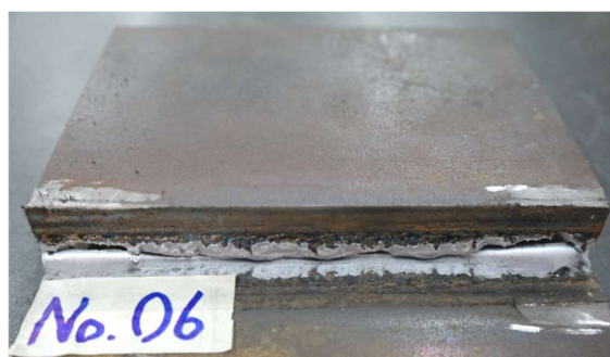
รูปที่ 9 ผลการทดสอบการพังทลาย (Fracture Test)
