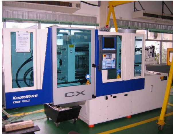
รูปที่ 14 เครื่องฉีดพลาสติกที่ใช้ในการฉีดจริง
