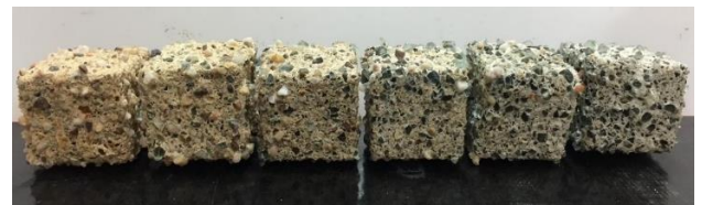
(ข) ซีเมนต์มอร์ตาร์ที่มีเศษกระจกรถยนต์เป็นส่วนผสมร้อยละ 0 20 40 60 80 และ 100
