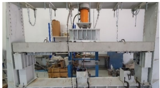
รูปที่ 9 ตำแหน่งติดตั้ง LVDT ขณะทำการเสริมกำลังด้วยระบบอัดแรงที่หลังโดยใช้แผ่น CFRP
