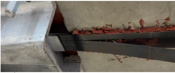
รูปที่ 17 การฉีกแยกของแผ่น CFRP ตามทิศทางของเส้นใยคาร์บอน ที่บริเวณอุปกรณ์สำหรับจับยึดแผ่น CFRP ของตัวอย่าง S2-20
