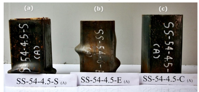
รูปที่ 5 ลักษณะการวิบัติของตัวอย่างเสา
