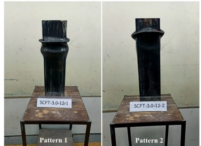
รูปที่ 6 เปรียบเทียบลักษณะการวิบัติของเสา CFT ที่ถูกเสริมกำลังโดยเหล็กเส้น 2 รูปแบบ
