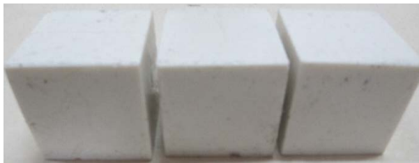
รูปที่ 2 ตัวอย่างทรงลูกบาศก์จากขี้พริ้ว (F100) ขนาด 5 x 5 x 5 เซนติเมตร
