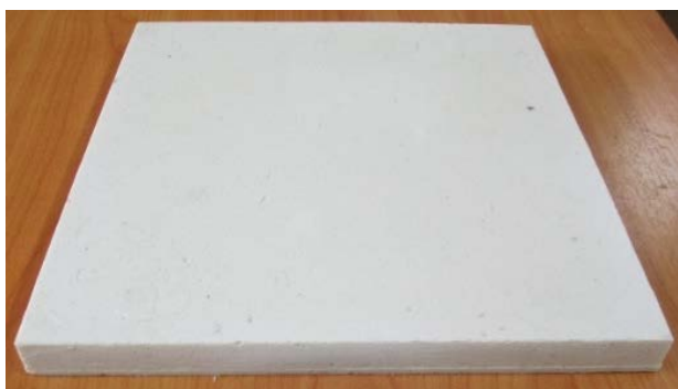
รูปที่ 3 ตัวอย่างแผ่นปูพื้นทางเดินจากขี้พริ้ว (F100) ขนาด 30 x 30 x 2 ซม.
